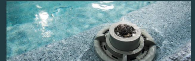
Vous avez besoin de peu de choses pour obtenir une eau cristalline. Le skimmer pré-installé filtre l'eau en deux étapes. Les feuilles et les grosses impuretés restent bloquées dans le panier pré-filtre. Les matières en suspension et les particules ultra-fines sont filtrées par le filtre à cartouche. L'eau est désinfectée au moyen d'un produit désinfectant placé dans le panier du skimmer.
